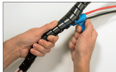
3) Puxe a ferramenta de aplicação de forma que os cabos fiquem dentro do Helawrap.
