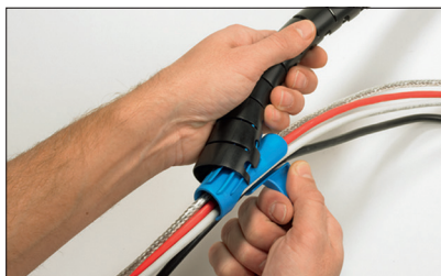
2) Encaixe o Helawrap na ferramenta de aplicação.
