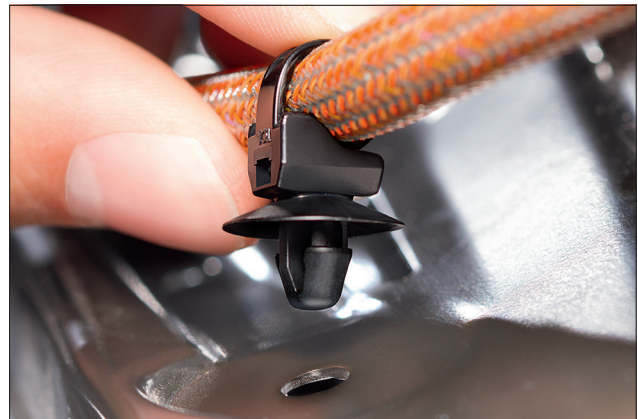
O disco na cabeça da abraçadeira protege o furo contra a entrada de sujeira.
